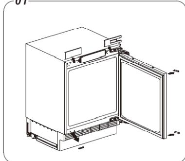
Установите морозильную камеру вертикально. Откройте дверь, удалите верхнюю крышку петли (левую и правую). Удалите нижнюю винтовую заглушку корпуса. Удалите нижнюю винтовую заглушку дверцы.
