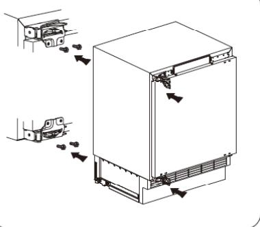
Разверните петлю и прикрепите ее к диагонально противоположному углу корпуса. Привинтите на место. Повторите с другой петлей. Перевесьте дверь и прикрепите петлю. Перед окончательным затягиванием винтов петли, проверьте, чтобы дверь была выровнена по горизонтали и вертикали, а уплотнитель целый со всех сторон.
