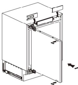
Установите верхнюю крышку петли (левую и правую). Установите нижнюю винтовую заглушку корпуса. Установите нижнюю винтовую заглушку дверцы.
