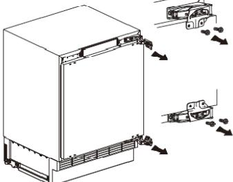
При закрытой дверце снимите винты снаружи петель. Откройте петлю по направлению от морозильника. При открытой петле отсоедините винты, прижимающие ее к корпусу. Будьте осторожны с петлей, используйте длинную отвертку с рукояткой, если таковая имеется.
