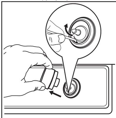
4. Тонкой отверткой отрегулируйте положение винта обводного клапана (А).
