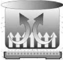
Индукционный нагрев обеспечивается электромагнитным полем. Индукционная катушка внутри плитки создает электромагнитное поле, которое вызывает нагрев посуды, стоящей на поверхности плитки. Исходя из природы процесса нагрева, существуют требования к посуде, применяемой для индукционных плиток.
