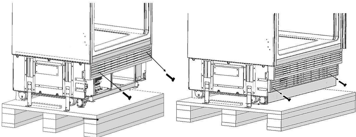
Для обеспечения безопасности при эксплуатации прибора его будет необходимо надежно зафиксировать, используя крепления к кухонному шкафу или к стене.
