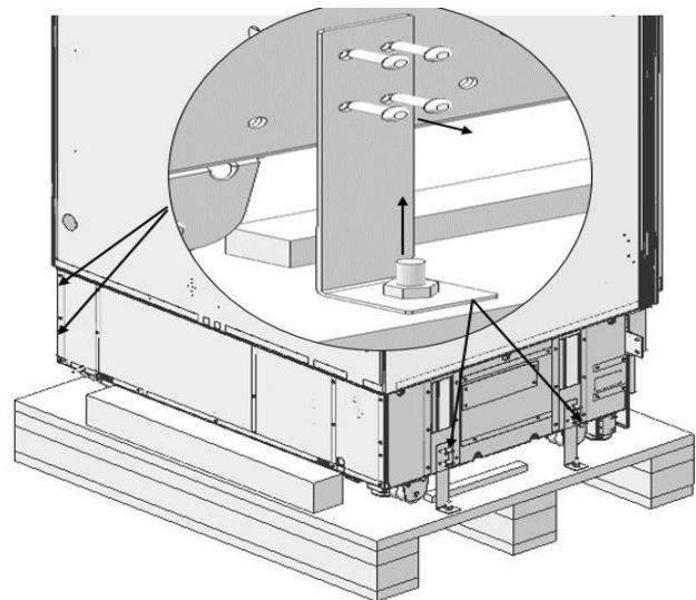
A/D - поверните по часовой стрелке, чтобы поднять переднюю сторону.
