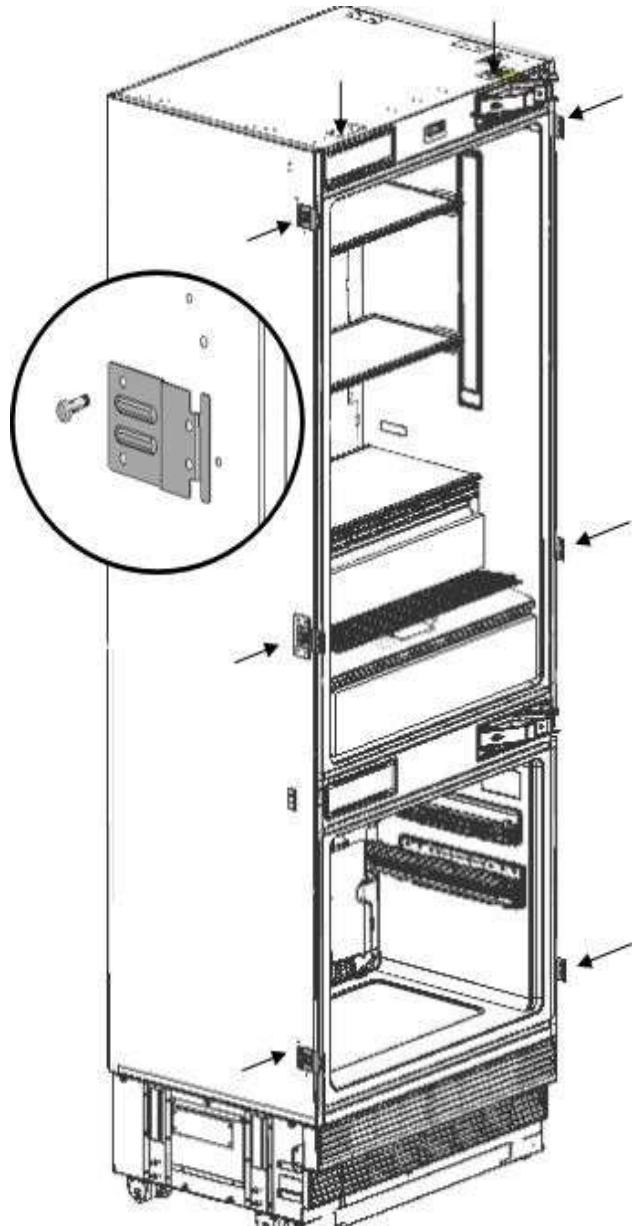
Установите верхний вентиляционный щит и привинтите его с помощью двух шурупов.
