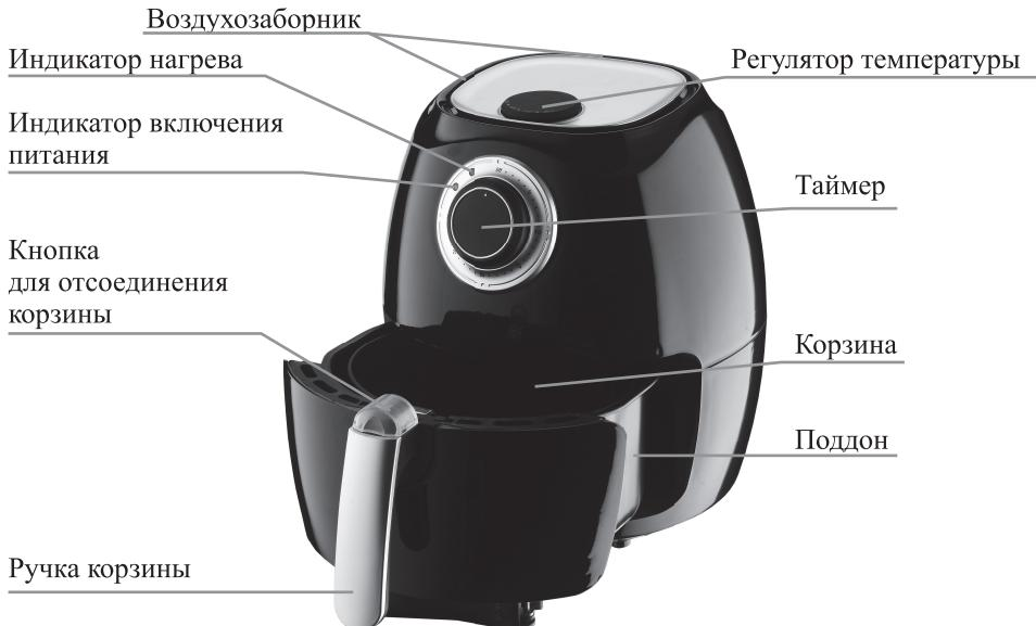
Принцип работы аэрогриля основан на конвекции воздушных потоков от нагревателя внутри рабочей емкости. Вентилятор, расположенный в верхней части аэрогриля, приводит в движение воздушные массы, нагретые до высокой температуры теневым нагревателем. Горячий воздух циркулирует внутри рабочей емкости аэрогриля и нагревает продукты до нужной кондиции.
