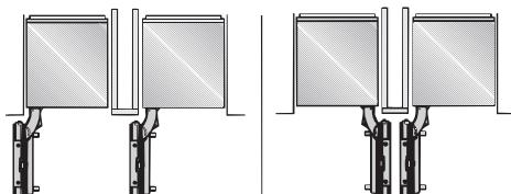
Если между приборами, расположенными рядом, есть промежуточная стенка толщиной **между 16 мм и 160 мм**, то приборы поочередно крепятся прилагаемыми монтажными материалами в нишу. Дополнительно потребуется монтажный комплект Side-by-side.
