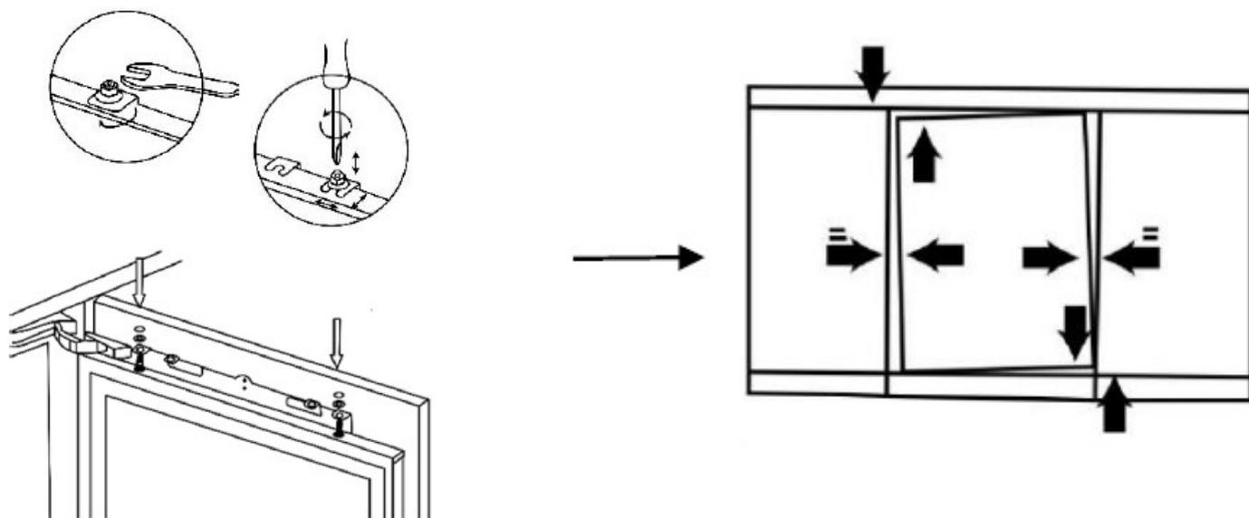
**10.** Закрепите 2 x L-образные дверных кронштейна в нижней части двери прибора на дверце шкафа с помощью винта с головкой 4 x шестигранником (2 в каждом кронштейне). Вам понадобится просверлить отверстия в задней части двери шкафа для винтов, если это так, то просверлите отверстия 2 x 2,8 мм Ø на глубину 10 мм.
