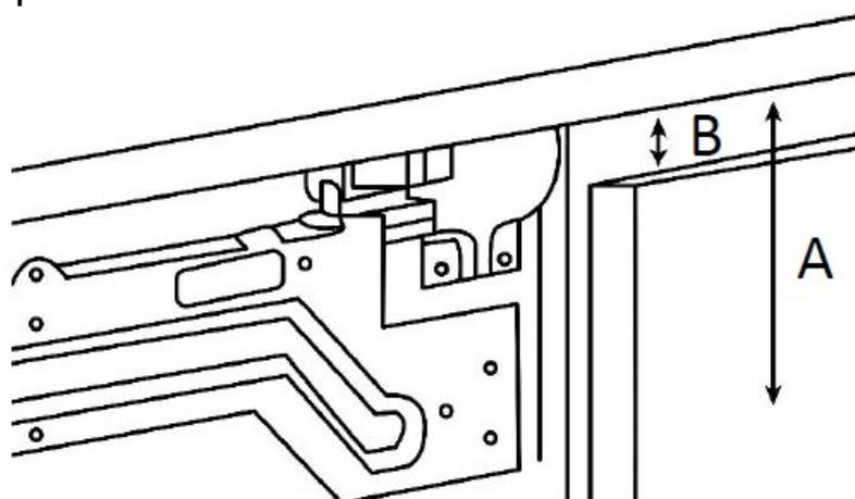
6. Снимите 2 винта, которые крепят крепежный кронштейн к двери прибора, и осторожно снимите крепежный кронштейн. На задней стороне двери шкафа (сторона, которая не будет видна) отметьте вертикальную линию от центра приблизительно 15 см от верхней части двери.
