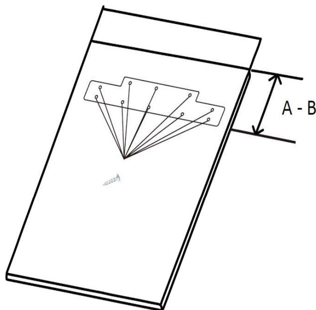
**8.** Установите дверцу шкафа с крепежным кронштейном, прикрепленным к верхней части дверцы прибора. Закрепите на месте с помощью 2 винтов, которые были удалены при снятии крепежного кронштейна с двери прибора.
