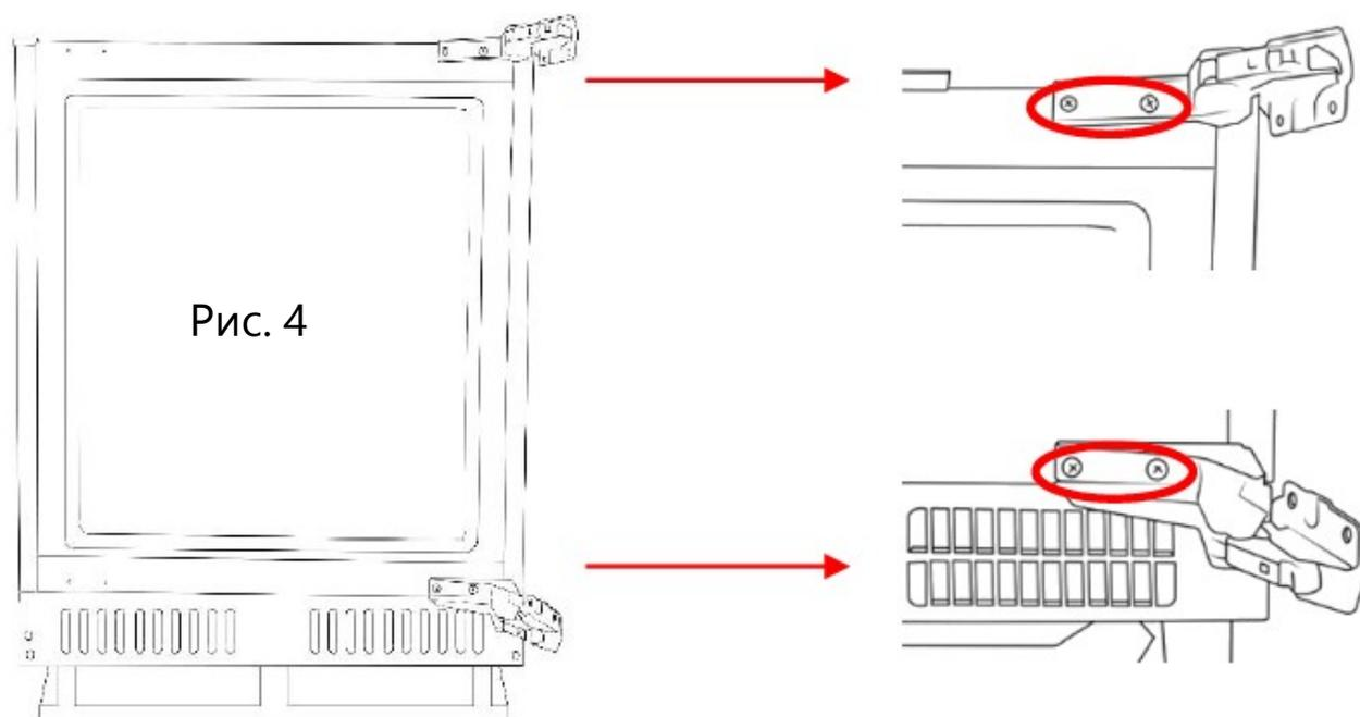
6. Переверните верхний шарнир (на 180°) и закрепите его на диагонально противоположном углу шкафа прибора рис.5
