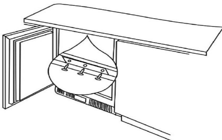
**12.** Откройте дверь и установите шарнирную крышку с внутренней стороны петель.
