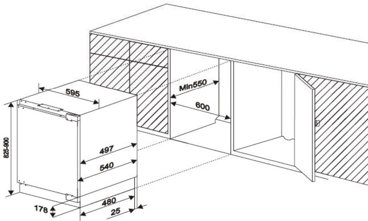
2. Отрегулируйте высоту прибора с помощью 4 ножек (2 сзади и 2 спереди). Высота регулируется от 820 мм до 870 мм. При необходимости применяйте гаечный ключ.
