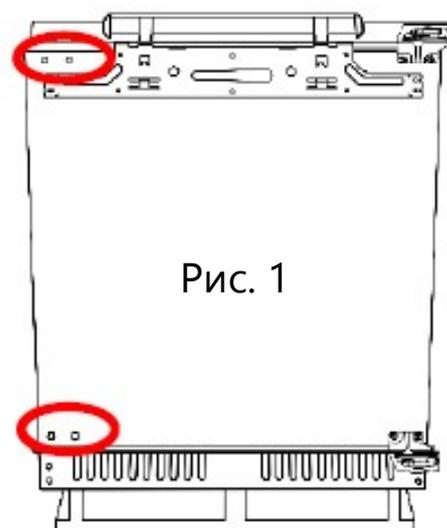
**2.** При закрытой двери снимите винты с верхней и нижней петель, которые удерживают дверь прибора на петлях. Сначала снимите винты с верхней петли, потом с нижней (Рис.2).
