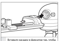
конец вала плотно вошел в квадратное отверстие фиксатора. Может потребоваться вращение насадки в ту или другую сторону. Когда насадка займет правильное положение, штифт на насадке войдет в паз на кромке соединительной втулки.
