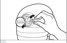
Поверните крепежный винт против 2 часовой стрелки, чтобы отсоединить колпачок.
