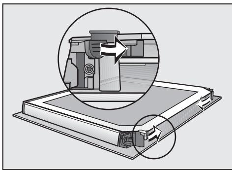
■ Закройте оба стопора дверных панелей, повернув их внутрь.
