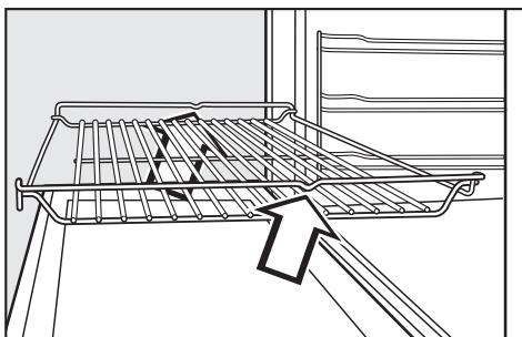
Задвиньте элементы с фиксатором назад.
