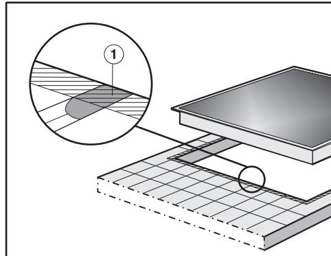
Не используйте никакие герметики, кроме случаев, когда это обязательно требуется. Уплотняющая лента под краем верхней части прибора обеспечивает достаточную герметизацию между прибором и столешницей.
