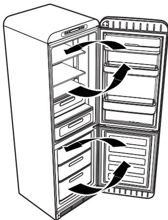
Система внутренней вентиляции позволяет быстрее охлаждать продукты и обеспечивает равномерное охлаждение внутри прибора.
