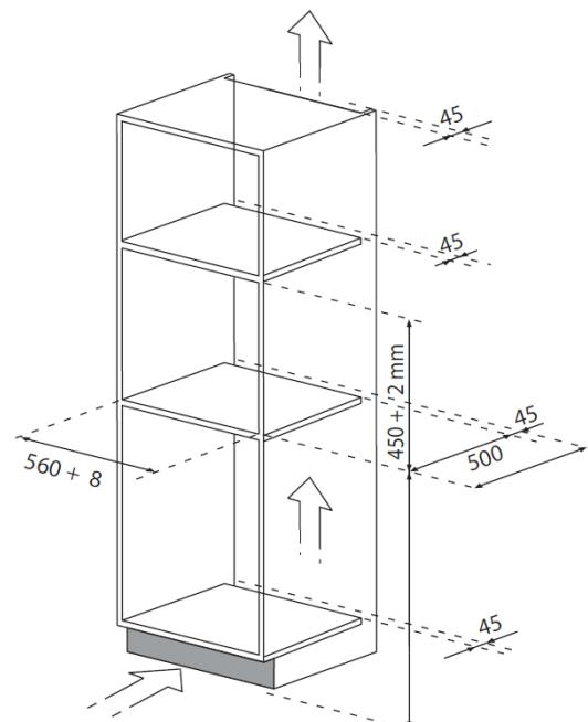
Прикрепите направляющие к стенкам колонны, как показано на рисунке. Закрепите направляющие специальными винтами, входящими в комплект поставки, после чего полностью извлеките до упора. Если кофемашина установлена над ящиком для подогрева посуды, то его верхнюю часть можно использовать как помочь при позиционировании направляющих. В этом случае опорная поверхность не требуется.
