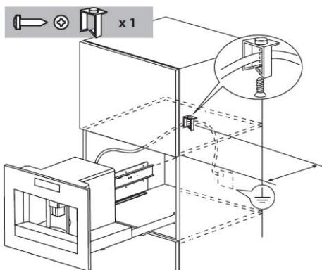
Установите прибор на направляющие. Следите за тем, чтобы штифты вошли в соответствующие отверстия. Закрепите прибор соответствующими винтами, входящими в комплект поставки.
