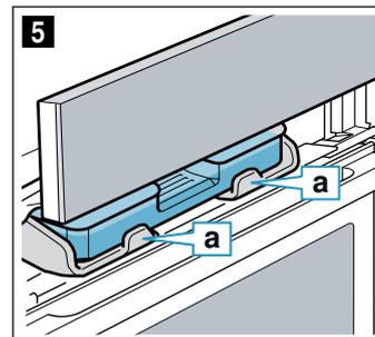
7. Медленно передвиньте панель вниз, затем отожмите её назад, пока она полностью не закроется. Резервуар наполнен. Теперь можно запустить режим с использованием пара.
