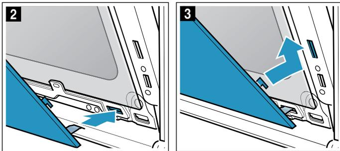
**Рекомендация:** Если переднее стекло не фиксируется, проверьте, не задевает ли оно ручку дверцы. Откройте дверцу шире, пока переднее стекло не зафиксируется.
