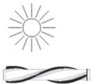
Дайте ролику высохнуть естественным путем в течение 24 часов. Затем вставьте ролик обратно в насадку и поверните фиксатор в положение блокировки.
