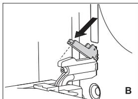
**В** Откиньте фиксаторы назад на 90° (при плавном закрывании дверцы, рис. 2).
