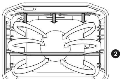
Одновременно работают верхний нагревательный элемент, инфранигреватель и вентилятор.
