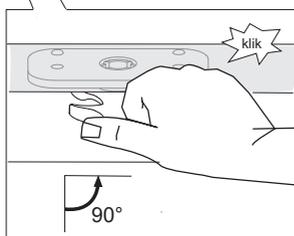
Пальцем отодвиньте замок вправо на  $90^\circ$  до щелчка. Замок дверцы заблокирован (в нерабочем состоянии).
