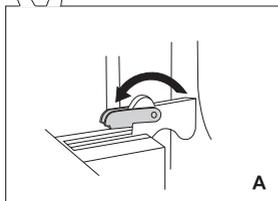
**2** А Откиньте фиксаторы до конца назад (при обычном закрывании дверцы).
