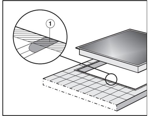
Стыки ① и заштрихованная область под поверхностью газовой панели конфорок должны быть гладкими и ровными, чтобы панель лежала ровно и уплотнение под кромкой верхней части прибора обеспечивало достаточную герметизацию столешницы.
