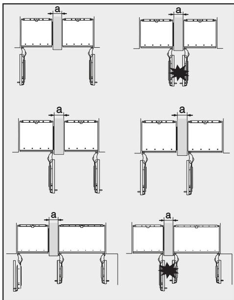
Если дверные петли соседних приборов располагаются рядом друг с другом, обязательно обратите внимание на толщину фронтальных панелей и дверных ручек, чтобы при одновременном открывании дверцы приборов не сталкивались и не повреждали друг друга.
