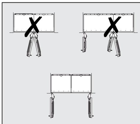
Если между винными холодильниками/приборами, расположенными рядом, нет промежуточной стенки, то они могут быть соединены друг с другом с помощью монтажного комплекта Side-by-side. Дополнительно необходимо установить нагревательный мат боковых стенок, чтобы избежать образования конденсата и, соответственно, повреждений прибора.
