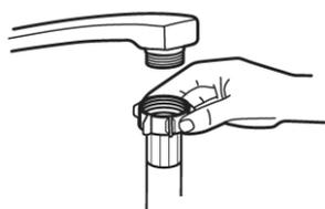
Подключите шланг для подачи холодной воды к соединительному колену с резьбой ¼ дюйма; при этом следите за прочностью соединения. Если трубы новые или не использовались в течение длительного времени, дайте воде стечь, пока она не станет прозрачной. Данная мера необходима для предотвращения засорения канала для подачи воды и повреждения прибора.
