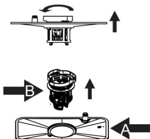
1. Поверните фильтр против часовой стрелки, выньте блок фильтров.
