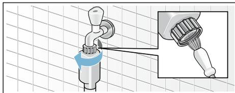
2. Для стандартных моделей и моделей с системой «Aqua-Secure» очистите сетчатый фильтр на задней стенке прибора: Отсоедините шланг от задней стенки прибора. Извлеките фильтр с помощью плоскогубцев и прочистите его.
