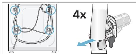
2. Выверните и снимите все 4 винта транспортировочных креплений. Снимите втулки. При этом извлеките сетевую кабель из держателей.
