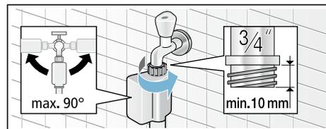
**Указание:** Осторожно откройте водопроводный кран и проверьте герметичность в местах соединений. Резьбовое соединение находится под давлением водопроводной воды.
