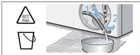
5. Осторожно отверните крышку насоса и выпустите остатки воды. Очистите внутреннюю поверхность, резьбу крышки насоса и корпус насоса. Прочистите насос внутри, резьбу крышки насоса и корпус насоса (лопастное колесо откачивающего насоса должно свободно вращаться). Установите крышку насоса на место и заверните её. Ручка должна находиться в вертикальном положении.
