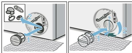
6. Установите крышку отсека для сервисного обслуживания на место.
