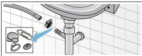
4. Подсоедините сливной шланг и зафиксируйте место соединения шланговым хомутом.
