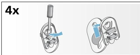
2. Вставьте все 4 втулки. Зафиксируйте сетевой кабель в держателях. Вставьте винты и затяните их.
