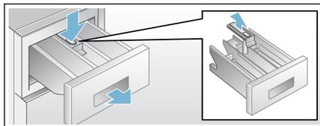
3. Промойте ванночку кюветы и вставку в воде с помощью щётки и просушите. Также выполните очистку корпуса внутри.
