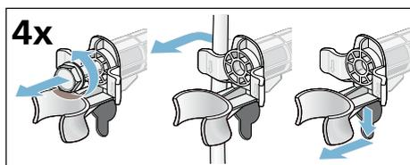
3. Вставьте заглушки. Зафиксируйте заглушки нажатием на стопорные крючки.
