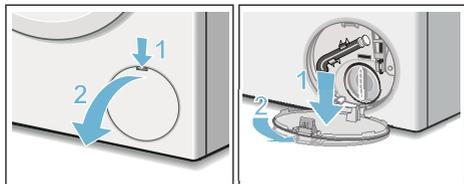
4. Выньте сливной шланг с держателя. Снимите крышку, слейте раствор моющего средства в соответствующую ёмкость. Установите закрывающую крышку на место. Вставьте сливной шланг в держатель.
